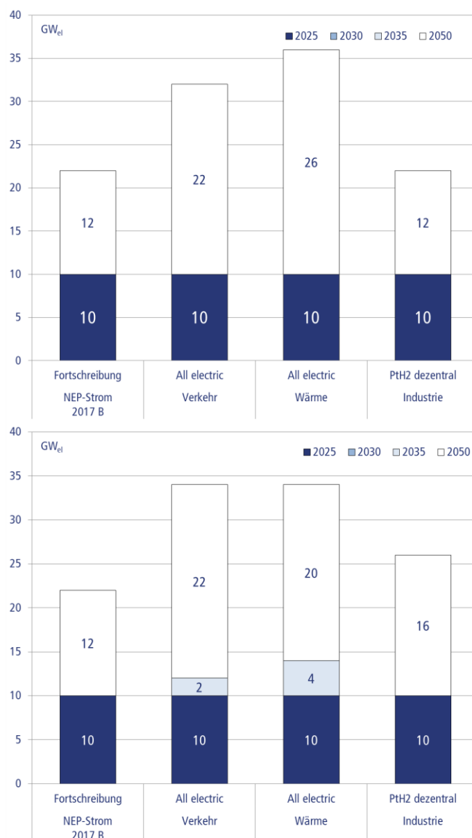
Abbildung 58: Benötigter Ausbau für Stromtransportleitungen (HGÜs) in GW ei bis 2050 im Szenario „Schnelle Energiewende“ (oben) und „Fokus PtG“ (unten)
