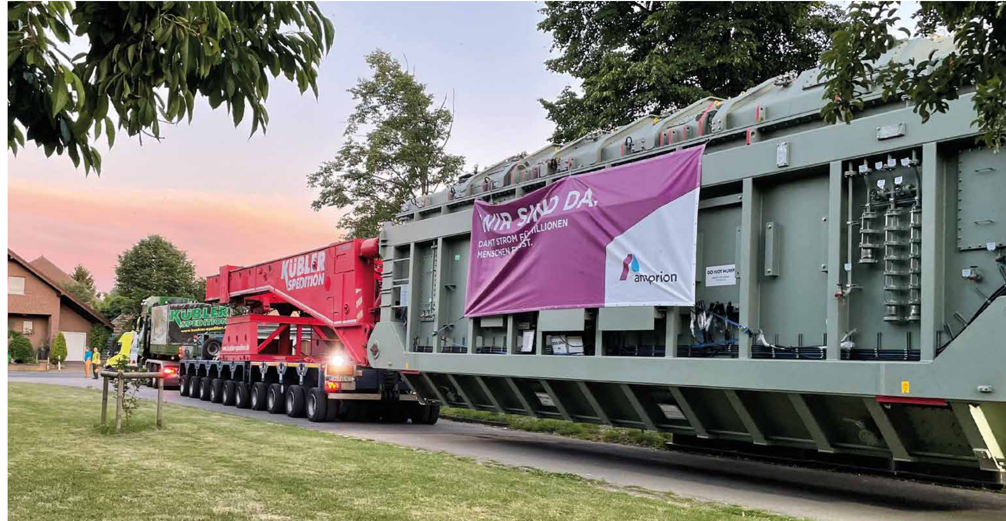
Transport von einem Transformator zur Umspannanlage
